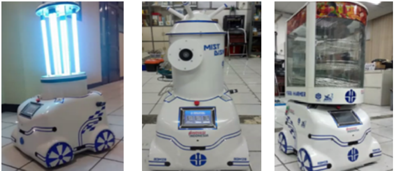
Gambar 3.52 Robot Otonom Multiguna (ROM 20) sebagai robot UVC, robot penyemprot disinfektan, dan robot pengantar makanan
